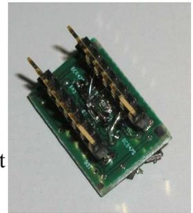
Das Ergebnis kann sich aber sehen lassen: Das Gepatchte Replacement (V2) sieht fast genau so aus wie das Original (um+2dBm nach oben geschoben) und wesentlich besser der erste Versuch (V1):
