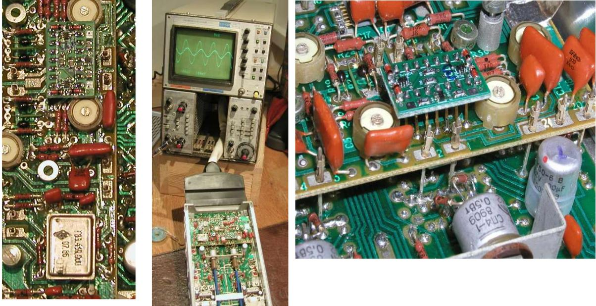
Legt man 0dBm ordentlich terminiert an zwei Einschübe des Oszilloskops (Linker Slot mit originalem 04KH009 bestueckt, rechter Slot mit Einschub und Replacement bestückt), so kann man den Verlust an Bandbreite deutlich sehen: Bei 10MHz (links) fast OK und bei 80MHz (rechts) schon schlecht:
